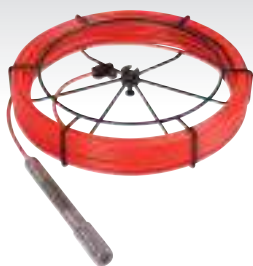
Сменный барабан с головкой камеры Ø 30 мм
